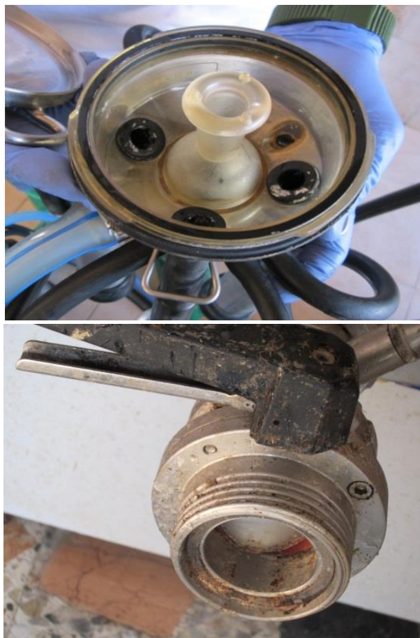
Particolare di un collettore, Particolare del bocchettone di uscita della vasca del latte
